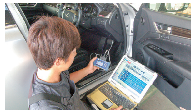
幅広い車種に対応できる故障・車検用診断機を導入。機械に故障コードと故障名称が表示される
