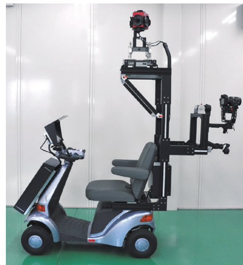
全天球撮影車。今回使用した車は公道を走れないが、将来的には乗用車に架台を取り付けることも可能だ
