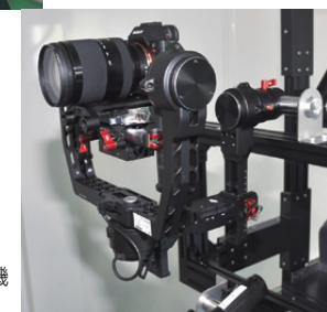
撮影機材に応じて3軸ジンバル、2軸・3軸アイソレータの防振機構を採用している
