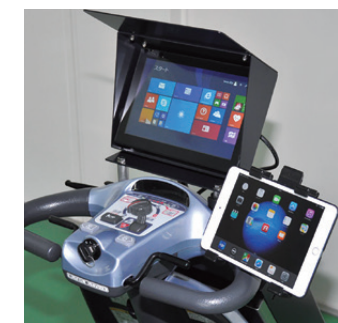
タッチパネルモニター、タブレット、スマートフォン等を複数搭載可能な運転席で、撮影をコントロールすることができる
