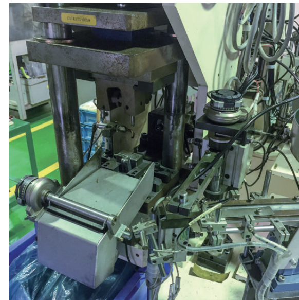
新たに開発したパイプオイルジェット曲げ加工機。油圧プレスに、パイプ曲げ加工機能としての回転機構を、ボルスターおよび金型に付加した
