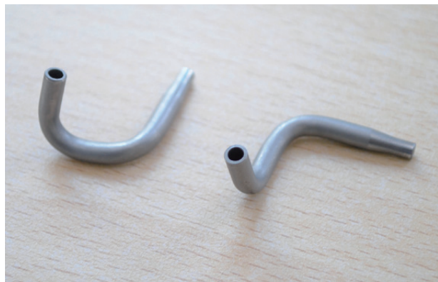
新たに開発した曲げ加工工法を活用し、3次元曲げ加工を施したパイプ
