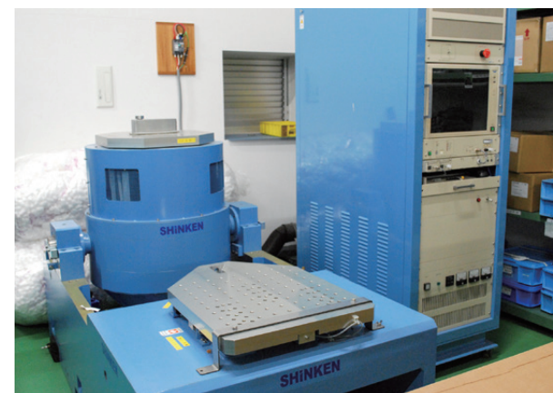
新しく導入した振動試験機。高速度カメラと併用して、振動時の変化を見極める
