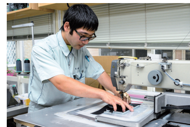
導入したコンピューターミシンは、タッチパネルで加工作業のデータを入力する
