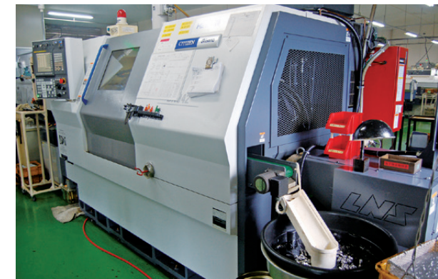
主軸台固定型CNC自動盤を使った工程の同時進行により、リードタイムの短縮を実現。1台で仕上がりがまで行える
