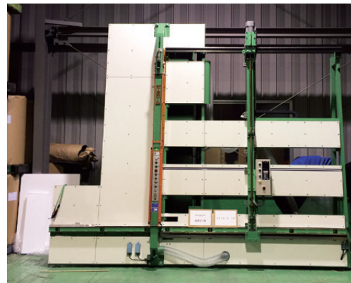
導入したパネルソー。発泡倍率2倍の極めて硬い硬質材料をカットすることができる
