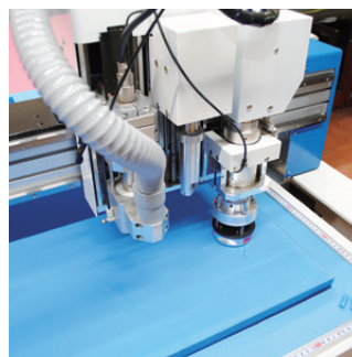
CAD/CAMデータを使い、型レス化を実現したサンプルカッター
