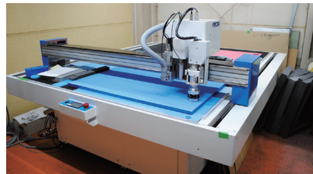
導入したパネルソー。発泡倍率2倍の極めて硬い硬質材料をカットすることができる
