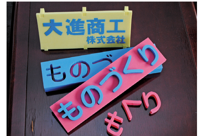
サンプルカッターで製作した、型レス化のサンプル。1個からでも製作可能
