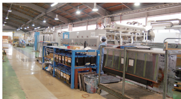
自動ラップ巻き機を導入した生産ライン。手前が給紙工程で、生産ラインの最後に自動ラップ巻き機が設置された
