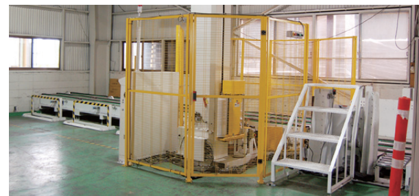
今回システムを開発・構築した自動ラップ巻き機。センサーでパレットと製品の大きさを把握し、適切にラップを巻く
