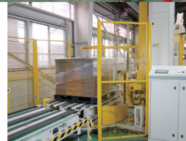
今回システムを開発・構築した自動ラップ巻き機。センサーでパレットと製品の大きさを把握し、適切にラップを巻く
