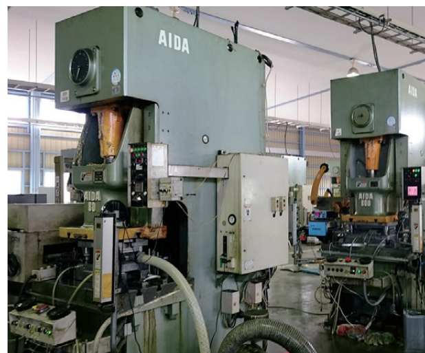
プレス機は、オートメーションで24時間稼働可能。作業者が直接製品に触れないため、高い安全性が確保されている
