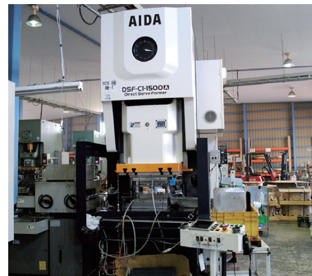
導入したサーボプレス機。加工する際の速度や位置決め、加圧する力などを高精度で制御でき、作業効率が向上
