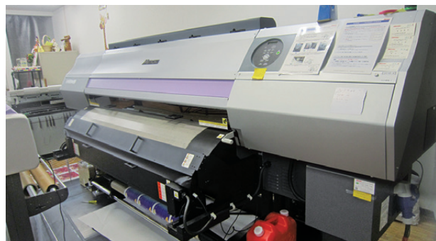
UVインクジェットプリンターは、乾燥時間がないので、すぐに納品できる。イメージに合わせて印刷する素材を選びプリントする
