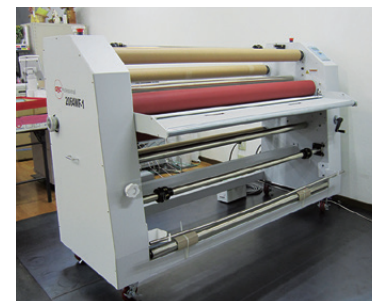
抗菌などの加工ができるラミネーター。手入れがしやすく、清潔さをキープできるほか、傷が付きにくく、雨による退色も防げる
