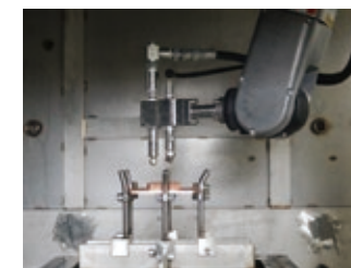
写真2. バリ除去(ワーク及びWJノズル)
