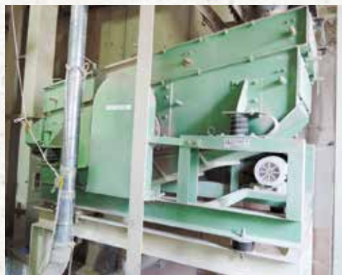
異物除去の精度を高める粗選機 VR-31 (浅野鉄工所)
