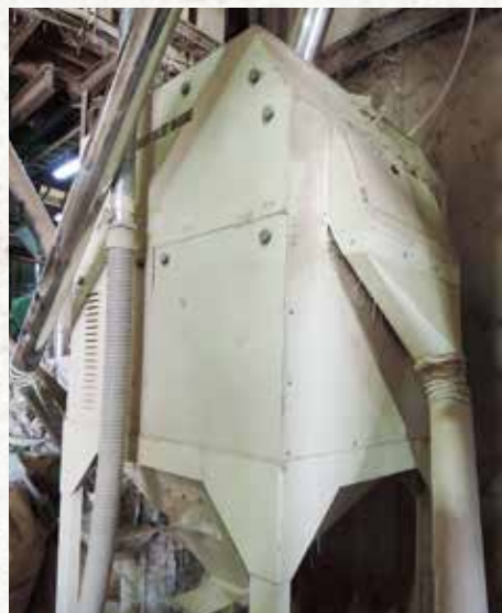
玄米から石を取り除く石抜機（丸七製作所）
