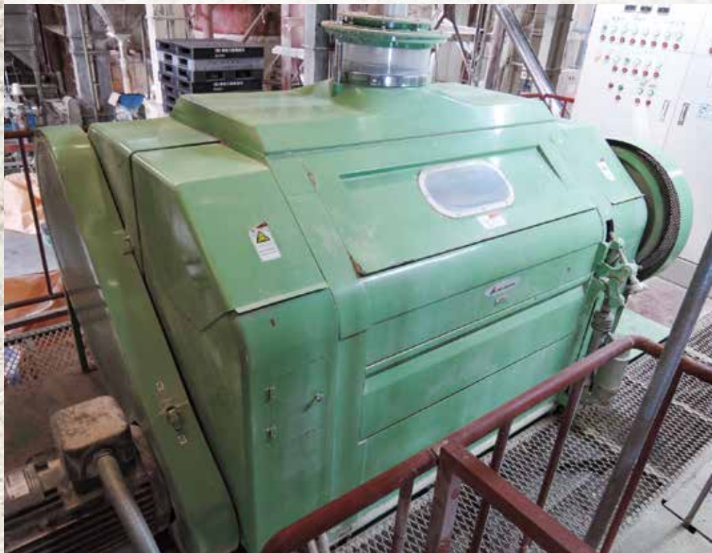
飼料用米をパウダー状に加工するロール粉碎機 ME3125 (明治機械)
