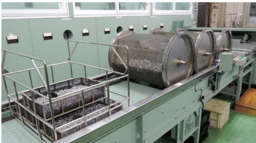
洗浄籠。手前がバスケット方式、奥が六角形のパレル方式
