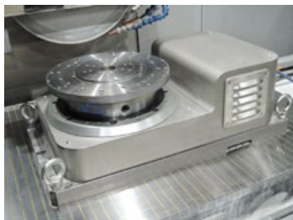
自主製品の「超精密 ロータリアタッチメント」。主に平面研削盤のロータリ研削に用いるアタッチメントとして開発
