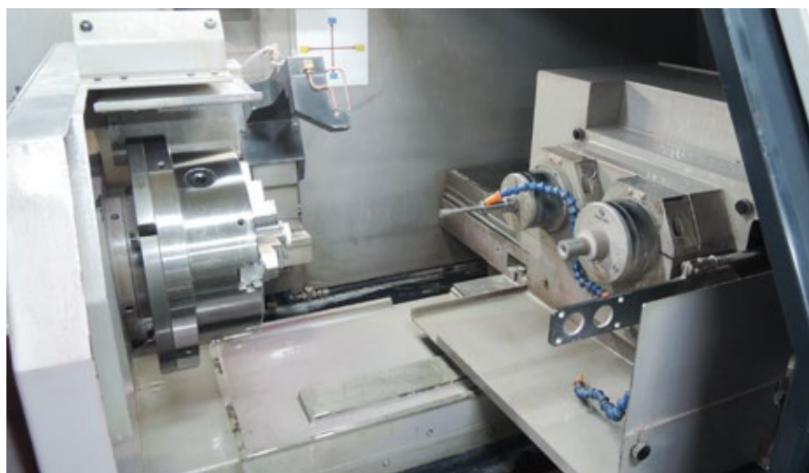
内面研削盤の内部。右側が2軸の高周波スピンドル
