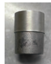
写真4.新型機で鑄造した鑄巣のない製品
