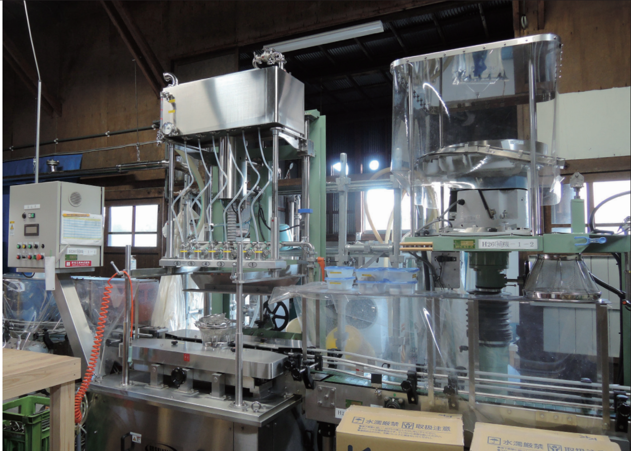
炭酸ガスを逃さない短時間瓶詰めライン
