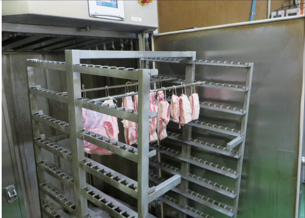
導入した発酵装置で庫内を発酵に最適な環境に維持する
