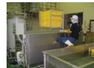
写真2.甘酒ストレートタイプ製品の殺菌作業風景。殺菌作業…本事業中 85度で60分殺菌
