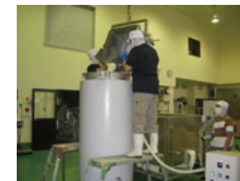
写真3.糀もろみ投入。糖化製造風景
