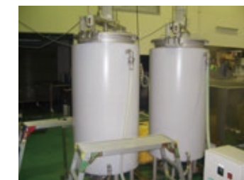
写真4.糖化タンク内を攪拌しながら糖化を促進する
