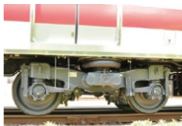
写真1. 従来型E233系車両足回り(左)と試験的車両E331系車両足回り
