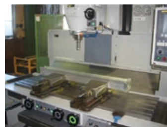
写真3. 山崎技研製YZ-500SG(Xストローク1,600mm)を使用した新工程
