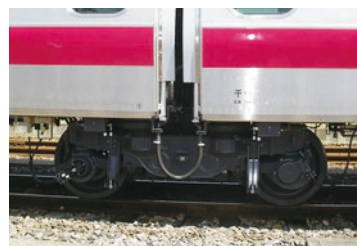
写真1. 従来型E233系車両足回り(左)と試験的車両E331系車両足回り
