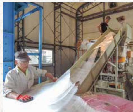
グラッシュミキサーにプラスチックフィルム廃材を投入
