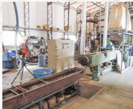
プラスチックペレットを生成する押出機
