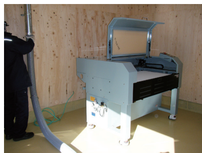
レーザー加工機。加工する部材にレーザー跡を付ける
