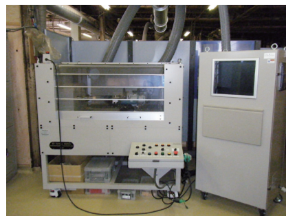
3Dターニングマシン。正確なホゾの斜め切りを実現
