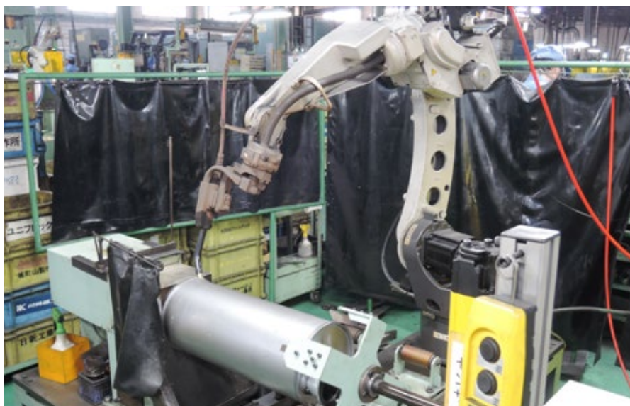
溶接とは反対側の缶体を固定するチャック装置(固定工具)自体も偏芯して回転する
