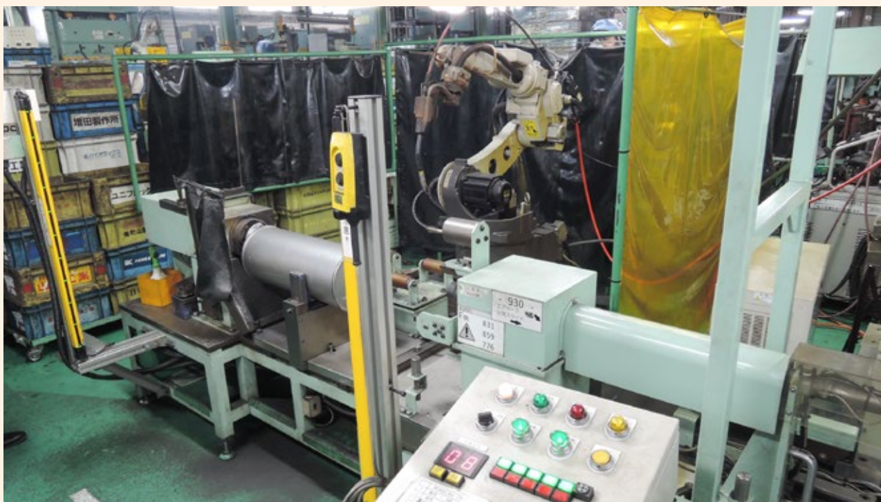
自動溶接機の全体。手前が自動機、中央が溶接ロボット
