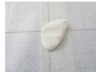
写真2. 簡易固定用に練り消しを使用、簡単に固定できる
