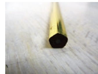
写真1. 5角形のため、印刷面が上にならない。専用台を作成し、印刷面を上固定することで解決
