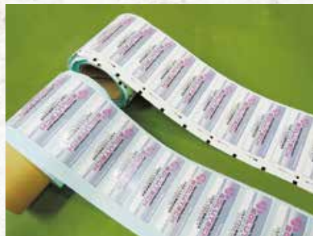
手前がハーフカット後のシールラベル。1枚ずつ切り込みが入り、裏紙でつながっている状態
