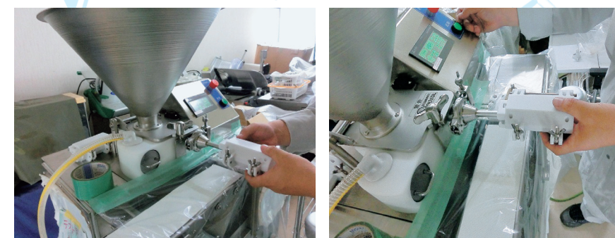
割り型にソーセージ生地を充填している様子
