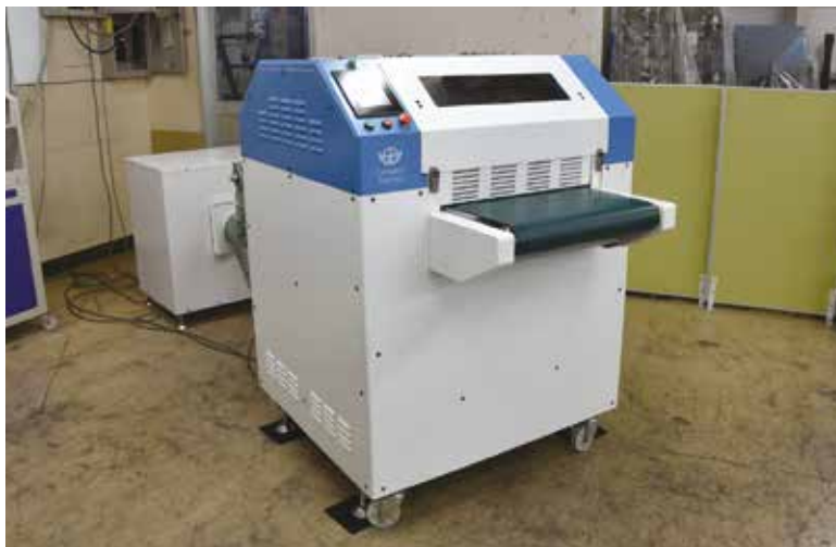
加工物に傷を付けず、設置スペースも従来品の3分の1で済むコンパクトバートル
