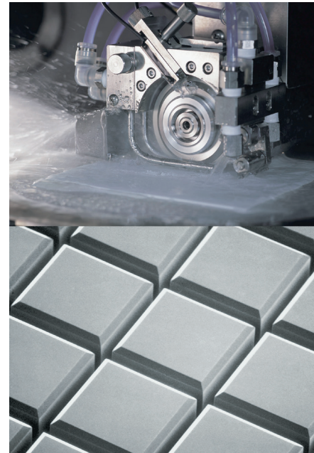
加工機（上）と加工を施したセラミックス
