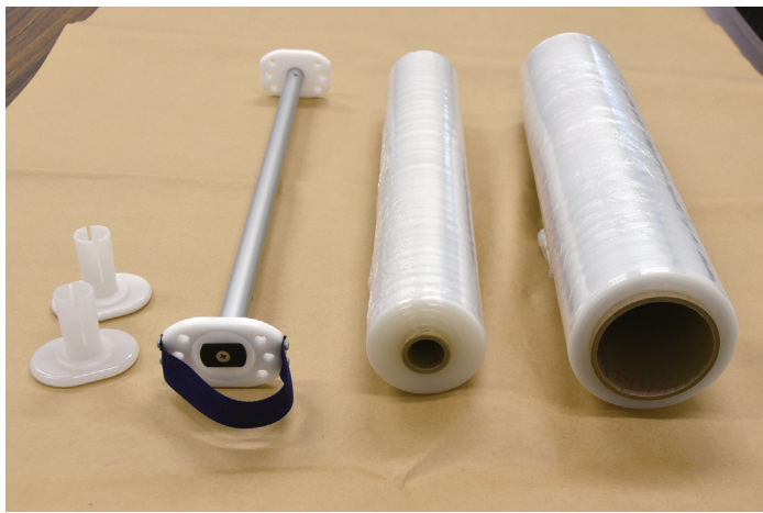
右から2番目が1インチ紙管。右端は3インチ紙管で、同じ長さのストレッチフィルムが巻かれている。左は簡易型のホルダーとシャフト付きのホルダー
