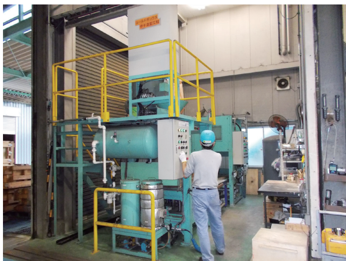
導入したコールドボックス造型機
