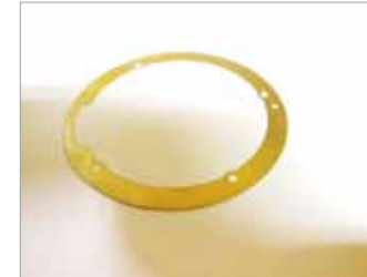
試作金型で打ち抜いた製品サンプル（板厚 0.03mmのワッシャー）
