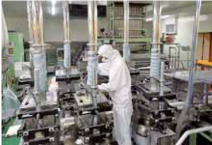
女性作業員・新人が清掃している様子。コンベアからベルトが簡単に取り外せるようになった。
