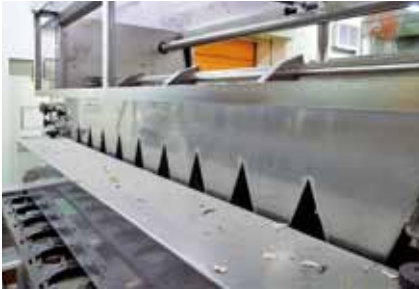
払出し装置の後の最終充填ホッパー。この部分も簡単に取り外しできるようになり時間短縮につながった。
