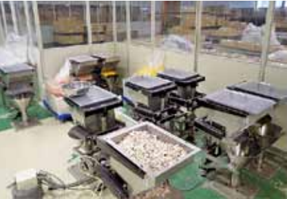
2階の加薬供給室と供給ホッパー。従来の装置よりホッパーの数が50%削減でき、さらにアレルゲンを含む乾燥具材を別の系統に移動できた。
