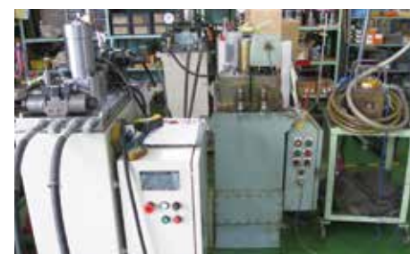
(図2) 油圧駆動源とモータ駆動源によるハイブリットシステム試作装置
