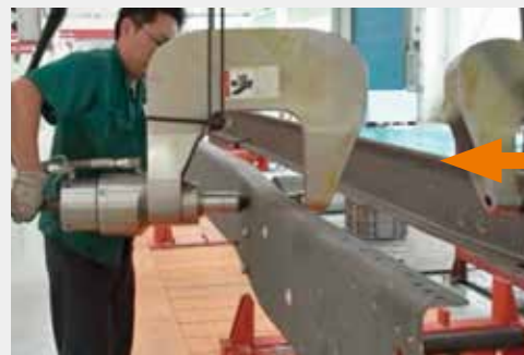
大型トラックのボディかしめ例
