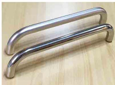
抗菌と抗金属アレルギー性質を兼ね備えた金属合金皮膜を施したサンプル品
