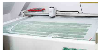
延反裁断機。CADデータを読み込むことで、正確で速い裁断が可能に
