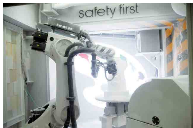
KUKA製「5軸ロボットアーム」
