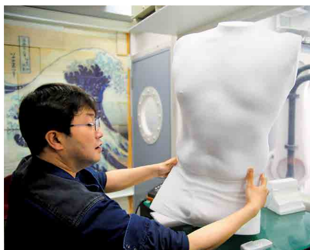
5軸ロボットアームで切削加工した人体模型
