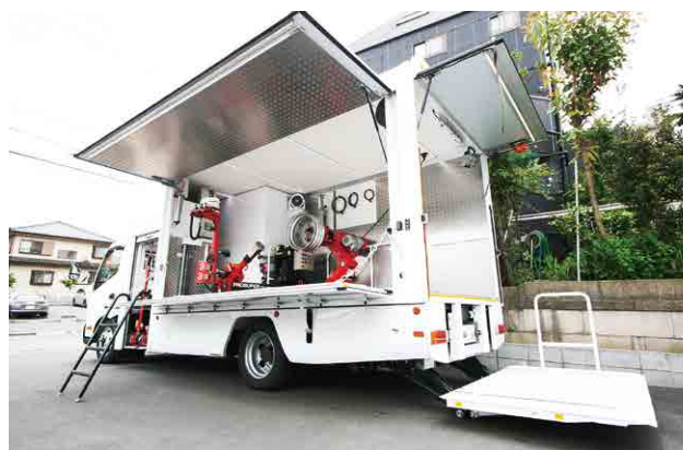
整備工場の機能が集約されている
