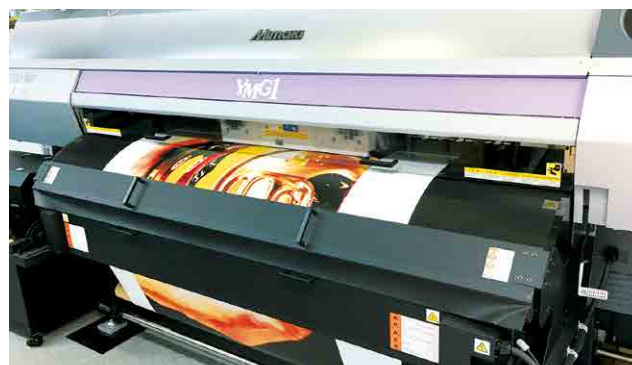
紫外線硬化型インクジェットプリンター (UJV500-160プリントシステム)
