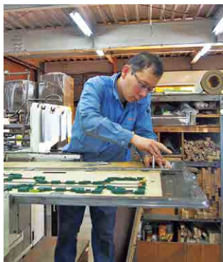
従来の木製の抜き型。大量生産に適する
