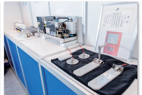
蒸気加湿器の中に組み込まれるPTC水中ヒーター
