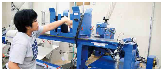
角材を投入すれば、あとの工程は自動で行われる
