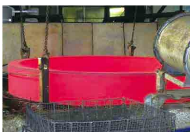
専用治具とクレーンを用い、水槽まで搬送
