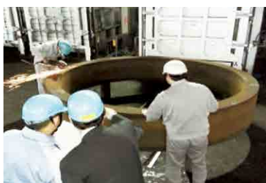
焼戻し(再加熱)完了後、製品を搬出し表面硬さ、ばらつきを測定
