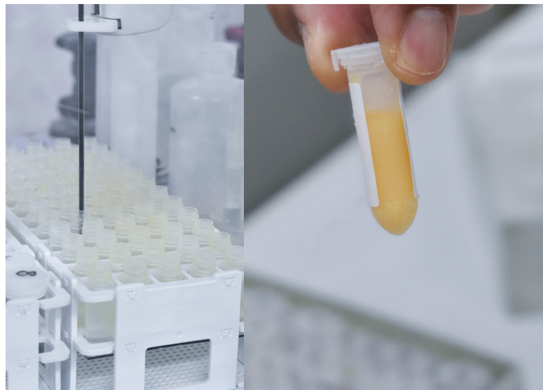
-80℃で保存されている検体を前処理して自動で連続測定できる装置へ移される
