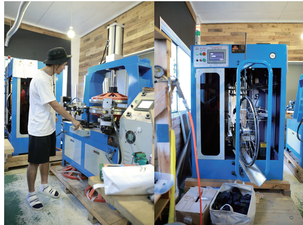
▲機械化でスポーク組み時間を大幅削減。スポークテンションを調整してホイールの回転を安定させる
