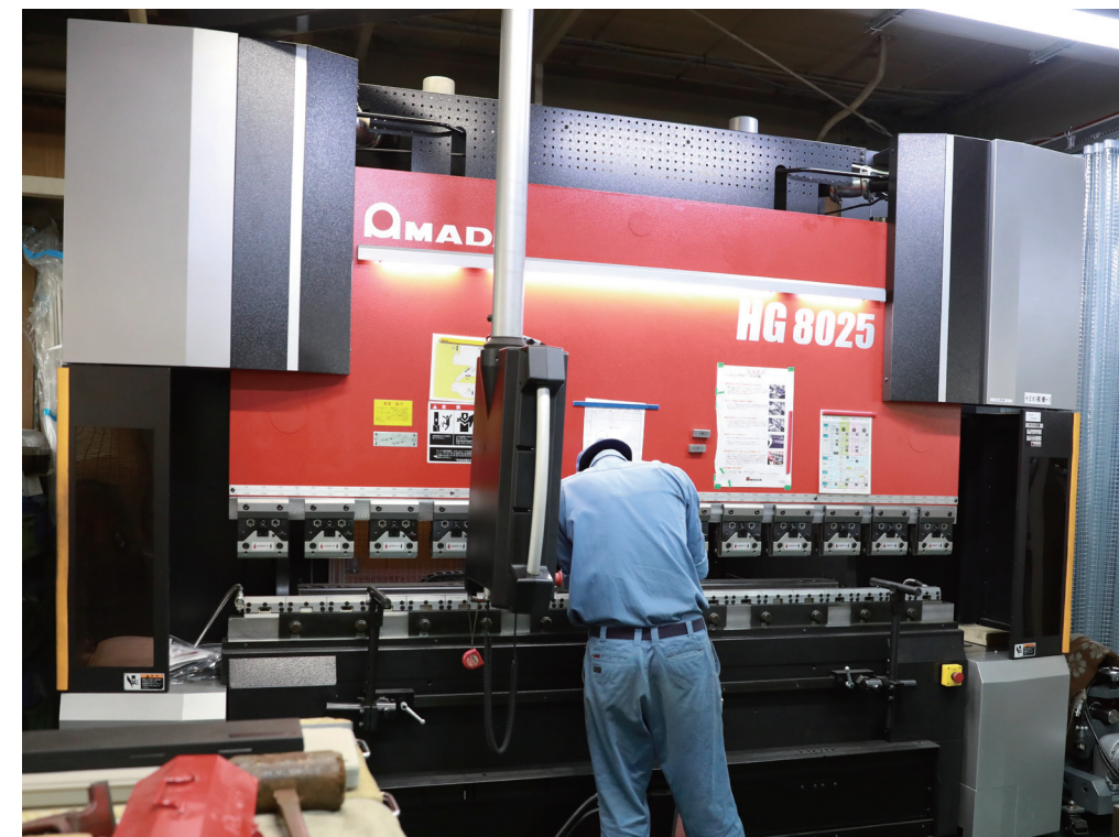
▲補助金で購入したアマダ社のベンディングマシン HG8025
