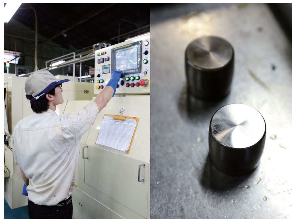
▲全自動精密端面研削盤の操作風景と、加工完了後のコロ
