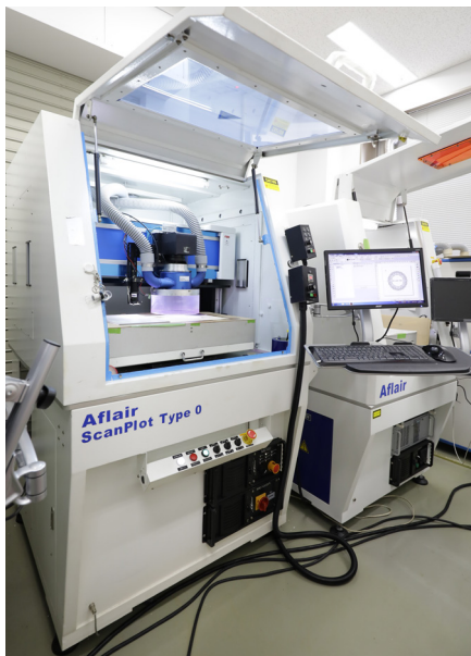
試作開発したレーザー加工機 集塵機能もつく
