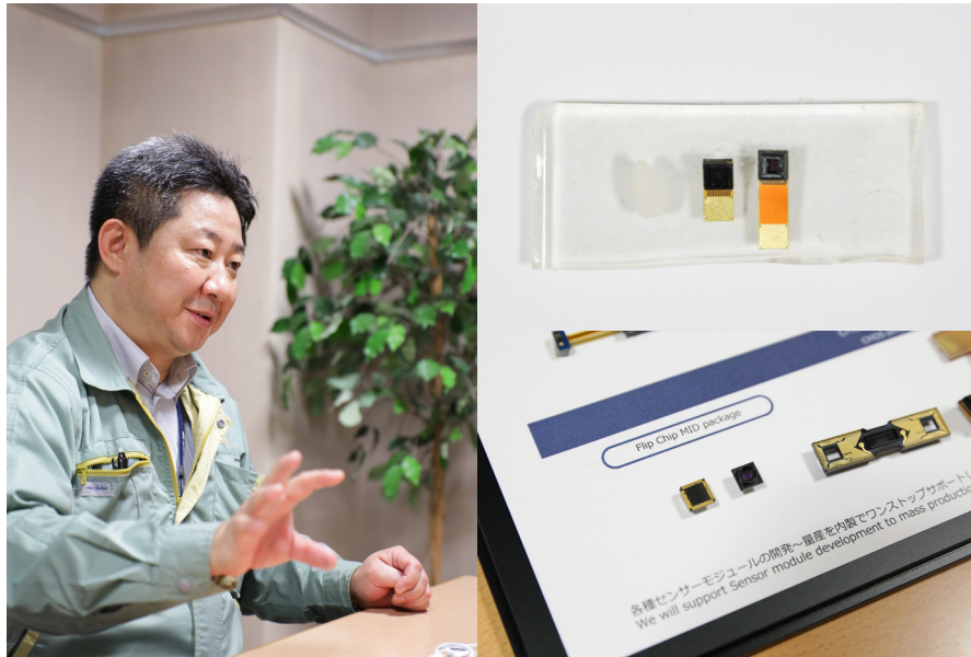
左/代表取締役の原園 文一氏 右上/米粒サイズの内視鏡用センサー 右下/フリップチップ実装見本 接合技術に当社のノウハウが詰まっている
