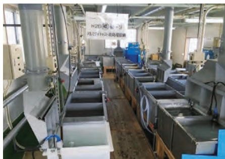
アルミダイキャスト用前処理設備
