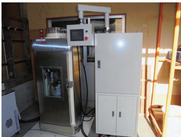
高压処理装置 L2-200/5A
