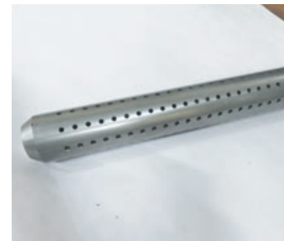
その他、導入機械で作ったノズル
