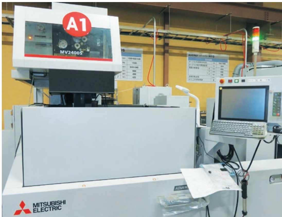
導入したワイヤ放電加工機
